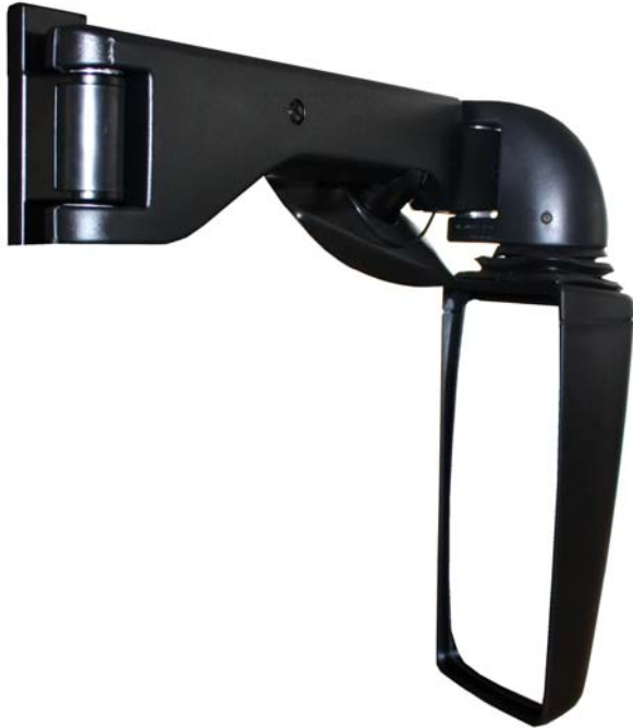
Spiegelarm rechts, beheizt 24V, elektrisch verstellbar, Abmessung: 565 x 514 mm, mit Bugbeobachtungsspiegel
